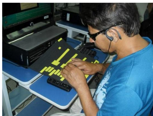
Figura 2. Usuário utilizando a interface em alto relevo confeccionada com E.V.A
