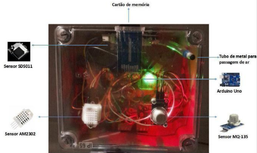
Figura 2 Composição do kit de monitoramento do ar.
