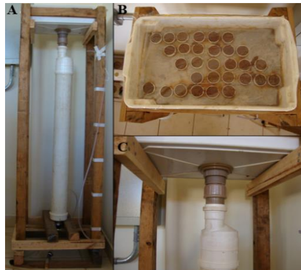
Figura 1. Mesa de tensão construída em colunas de policloreto de vinila (PVC) com areia. A. Vista geral do equipamento; B. bandeja com amostras de solo; C. detalhes das conexões de PVC. Fonte: Moreira et al. (2021).
