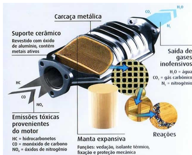
Figura 1: Estrutura e funcionamento de um conversor catalítico automotivo
