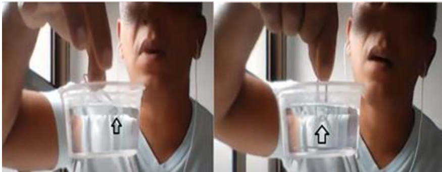
Figura 3: Experimento da tensão superficial, utilizando álcool 70% em clipe de metal.
