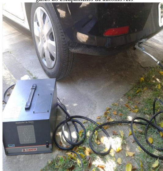
Figura 2- Registro fotográfico do equipamento sendo utilizado na análise dos gases do escapamento de automóveis
