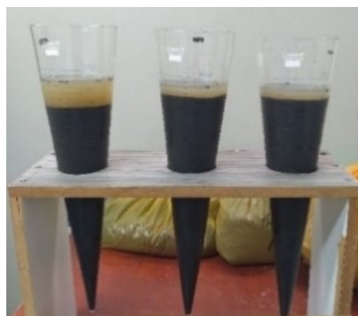
Figura 1. Amostra de lodo líquido em decantação no cone Imhoff
