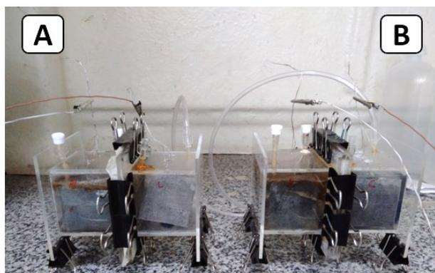
Legenda: (A) CCM equipada com membrana de látex e (B) CCM equipada com membrana de troca catiônica, com visualização das câmaras anódicas (esquerda) e catódicas (direita)
