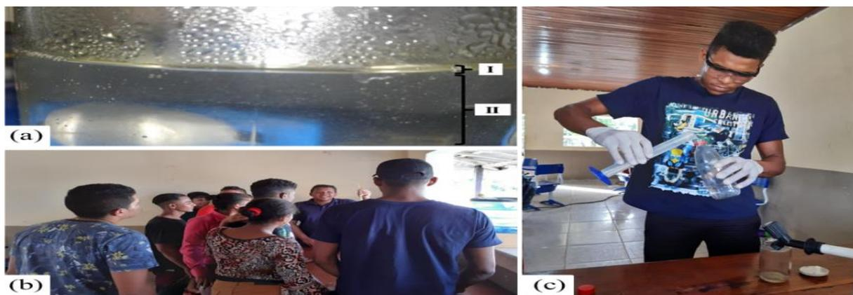
**Figura 4** – (a) mistura óleo essencial (I) hidrolato (II) obtido; (b) educandos acompanham as instruções para extração do óleo essencial de citronela; (c) Educando transfere a mistura coletada para frasco.
